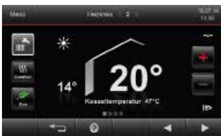
Vijf inch touchscreen met kleurendisplay van de Vitotronic 200 regeling (Type HO2B)
